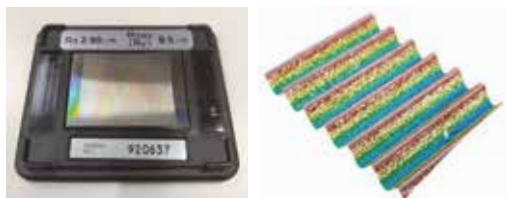
Érdesség etalon 3 \mu\text{m}
